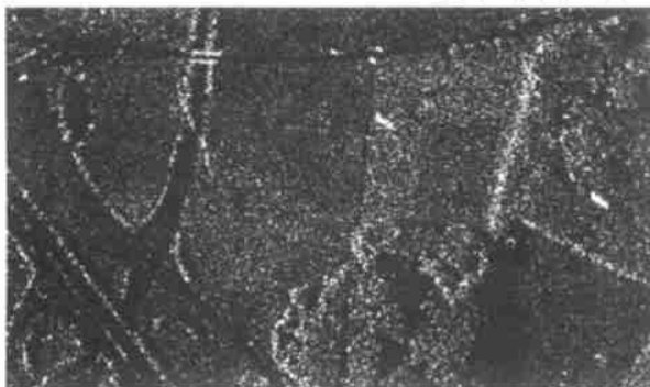
图 5 E-SAR 原始数据的快速 CBP 算法成像结果
